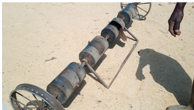
Semoir à riz, construction maison de Gérémi KOH (Bougnankou - Bénin). 8 rangs, 10 kg/ha /passage.
